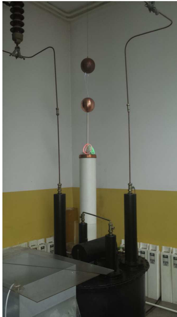
Slika 2.11. Preskok između terminala na sekundarnom namotaju i sferne elektrode
