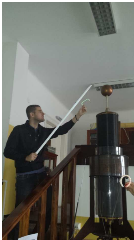
Slika 2.6. Teslin transformator na Elektrotehničkom fakultetu u Beogradu
